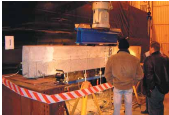
BELKA ŻELBETOWA Z NADBETONEM PRZYGOTOWANA DO BADAŃ WYTRZYMAŁOŚCIOWYCH NA MOSTOWYM STENIDZIE BADAWCZYM INSTYTUTU BADAWCZEGO DRÓG I MOSTÓW W ŻMIGRODZIE
