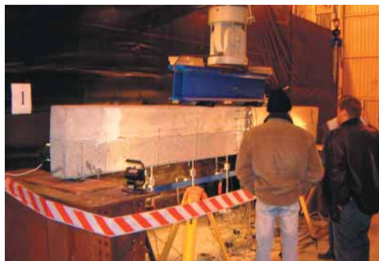
BELKA ŻELBETOWA Z NADBETONEM PRZYGOTOWANA DO BADAŃ WYTRZYMAŁOŚCIOWYCH NA MOSTOWYM STENIDZIE BADAWCZYM INSTYTUTU BADAWCZEGO DRÓG I MOSTÓW W ŻMIGRODZIE
