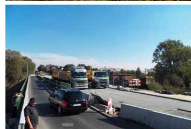
WIDOK SAMOCHODÓW CIĘŻAROWYCH NA OBLICZCIE PODCZAS PRÓBNEGO OBCIĄŻENIA, ORAZ WYKORZYSTANIA KŁADKI DO RUCHU WAHADLOWEGO
