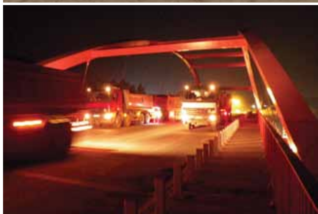
USTAWIANIE SAMOCHODÓW CIĘŻAROWYCH NA WIADUKCIE PODCZAS PRÓBNEGO OBCIĄŻENIA
