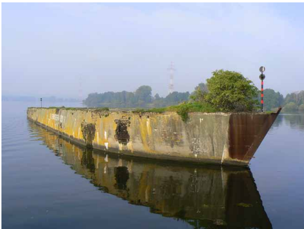
ATRAKCYJNA REJSU - PAMIĄTKA II WOJNY ŚWIATOWEJ - BUNKROWIEC, CZYLI STATEK ZBUDOWANY Z BETONU
