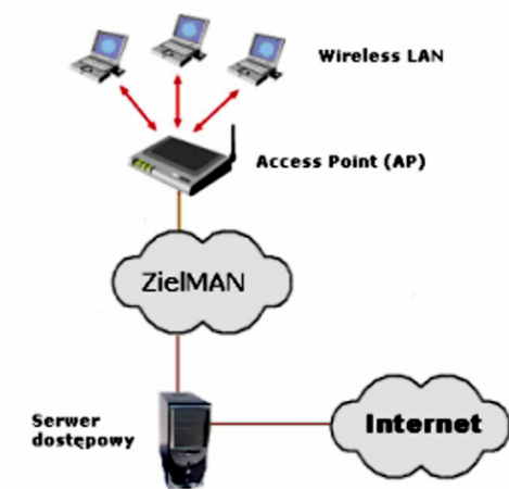
SCHEMAT PODŁĄCZENIA HOT-SPOTU NA RYNKU
