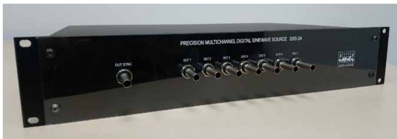
Fot. 2. Cyfrowy generator napięć sinusoidalnych opracowany przez zespół z Instytut Metrologii, Elektroniki i Informatyki (IMEI), pod przewodnictwem dr. hab. inż. Ryszarda Rybskiego, prof. UZ
