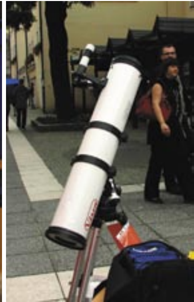
WSPÓLczesna wersja teleskopu zwierciadłowego, którego pierwszy prototyp wykonał Isaac Newton.
