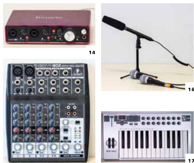
14 INTERFEJS FOCUSRITE SCARLETT 2 I 4 II GENERACJI (FOT. Ł. HŁADOWSKI) 15 KONSOLA BEHRINGER XENYX 802 (FOT. Ł. HŁADOWSKI) 16 MIKROFONY: AUDIOTECHNICA ATR6550 (NA STOJAKU) ORAZ SHURE PG48 (FOT. Ł. HŁADOWSKI) 17 KŁAWIATURA MIDI E-MU X-BOARD 25 (FOT. Ł. HŁADOWSKI)
