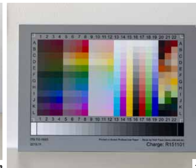
9 LAMPĄ ŚWIATŁA REFERENCYJNEGO GRAFILITE ORAZ ZESTAW PROFESJONALNYCH ZDJĘĆ TESTOWYCH KODAK COLOR MANAGEMENT CHECKUP KIT (FOT. Ł. HŁADOWSKI) 10 PLANSZA TESTOWA IT8.7/2 (FOT. Ł. HŁADOWSKI)
