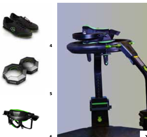
4,5,6 BUTY I CZUJNIKI RUCHU (TZW. TRACKERY) ORAZ UPRZĄŻ POZWALAJĄCA NA SWOBODNY I BEZPIECZNY OBRÓT W PLATFORMIE (MATERIAŁY PRODUCENTA) 7 BIEŻNIA WIELOKIERUNKOWA VIRTUIXOMNI (FOT. Ł. HEADOWSKI)
