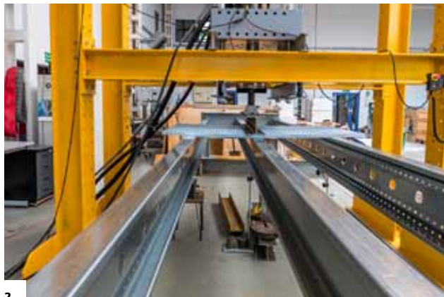
1. ZŁĄCZE ORAZ KRATOWNICA PODCZAS BADAŃ W LABORATORIUM INSTYTUTU BUDOWNICTWA UZ.
