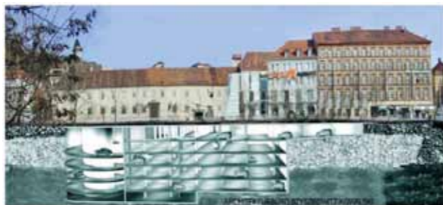
IL. 1. WIZUALIZACJA PODBUDOWY POD ISTNIEJĄCĄ ZABUDOWĄ W GRAZU. ŹRÓDŁO: HTTP://INZYNIERIA.COM/UPLOADS/IMAGES/ORIGINAL/UYQTWWQRZEJEWLHQZEPRQERKIPOUKMVPBRPIVZMDSJOHFRSPALJSBPVVKAP.JPG (DATA POBRANIA 14.01.2016)
